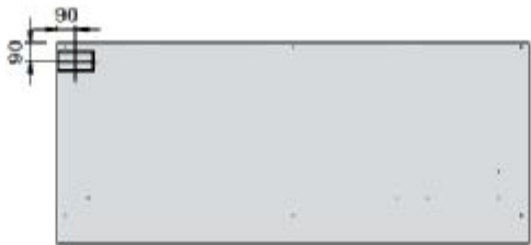
Alimentação Eléctrica Electrical Connection
